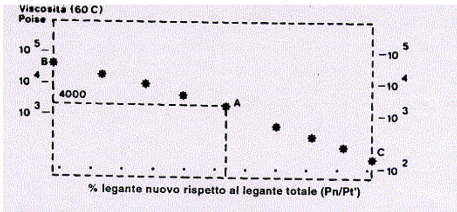
Indicando con A il punto le cui coordinate sono: il valore ottenuto di Pn/Pt ed il valore della viscosità di 4000 poise, l'intersezione della retta con l'asse verticale corrispondente al valore 100 dell'asse orizzontale, fornisce il valore C della viscosità del legante che deve essere aggiunto.
